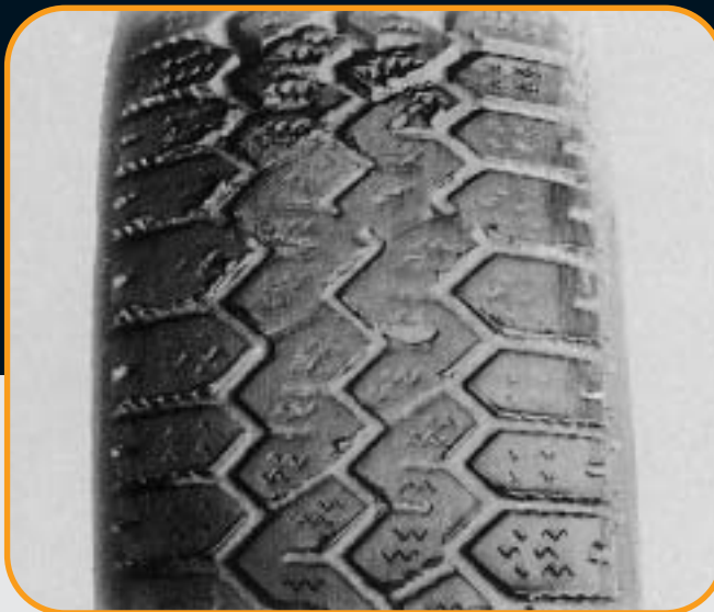
Těžké opotřebení vzniklé brzděním se zablokovánými koly • Severe wear due to full braking • Тяжелый износ, возникший путем торможения с заблокированными колесами
