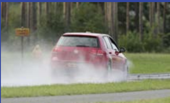
TENUTA SUL BAGNATO Il pilota guida zigzagando sul circuito per verificare la tenuta dei pneumatici sull'asfalto bagnato.
