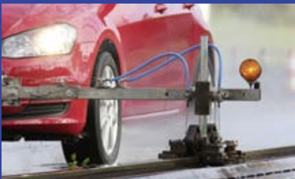
TEST DI FRENATA Il pilota, raggiunta una certa velocità, frena sull'asfalto bagnato. L'auto deve fermarsi alla barriera.
