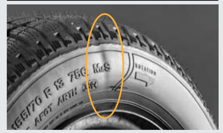
Einschnürung durch Überlappungsnaht der Karkasslage.
