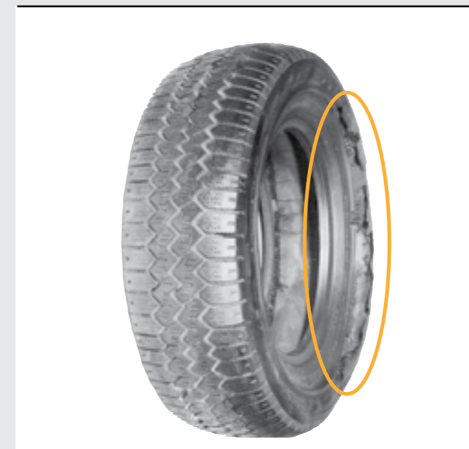
Starke Erwärmung wegen Fahrens mit erheblichem Minderdruck führte zu Separationen zwischen den Aufbauteilen und zu Verschmorungen des Gummimaterials.
