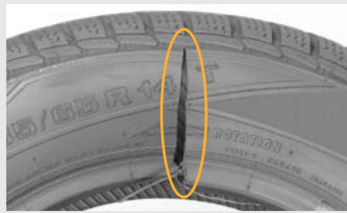
Gebrochener Kern durch zu hohe Zugspannung beim Füllvorgang.
