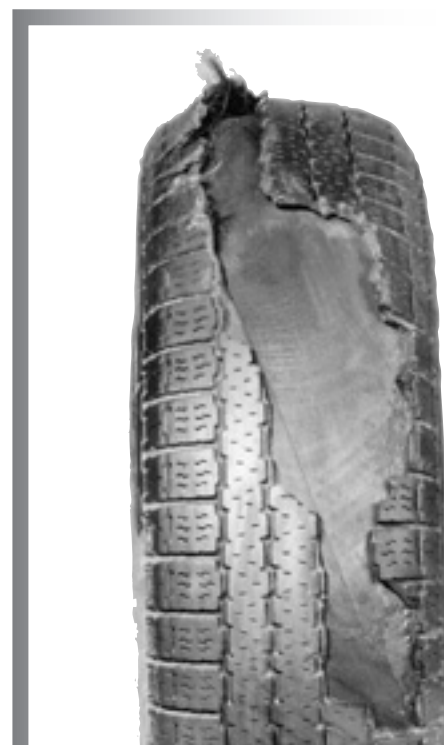
Abriss einzelner Reifenteile als Folge von Wartungsmängeln.
