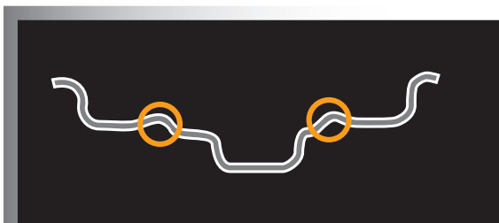
Felgenkontur mit beidseitigem Rund-Hump (H2)
