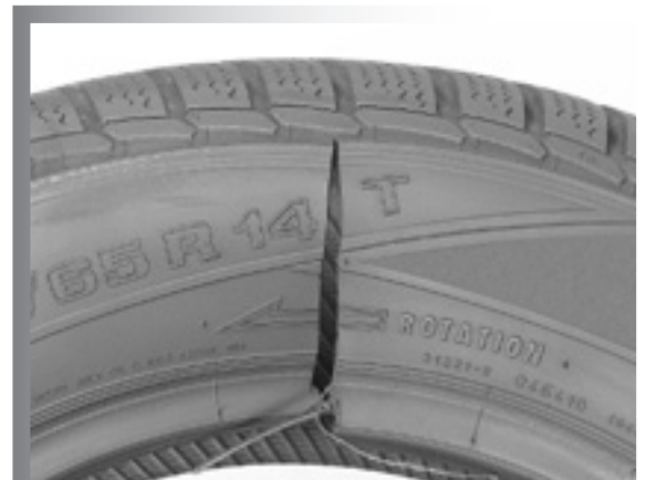
Gebrochener Kern durch zu hohe Zugspannung beim Füllvorgang.
