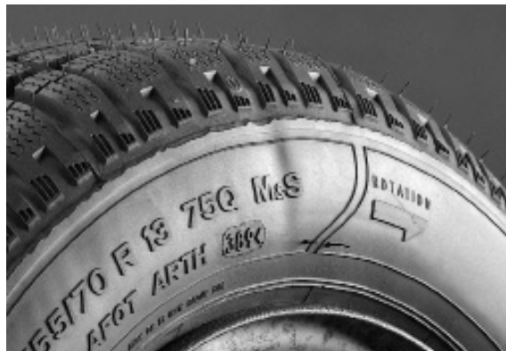
Einschnürung durch Überlappungsnaht der Karkasslage.
