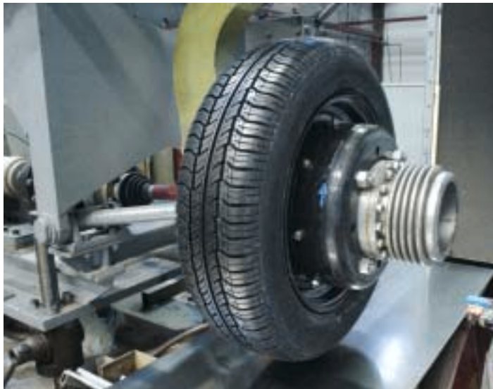
Il pneumatico di produzione Pirelli ripreso durante la fase di test; la gomma è montata sul mozzo della macchina prova pneumatici del Dipartimento di Energetica del Politecnico di Torino. Le caratteristiche della macchina sono state ampiamente descritte su Auto Tecnica - Maggio 2004.
