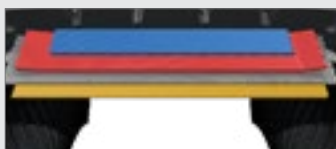
Ensemble de ceintures rigides ceinture supérieure pleine largeur et une protection des flancs améliorent la durabilité.
