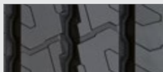
La géométrie des rainures centrales en zigzag augmente le nombre de rebords mordants pour améliorer la traction.
