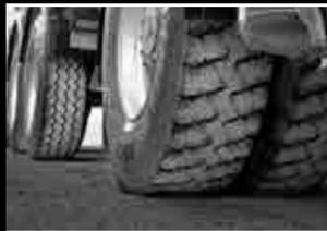
Die formstabilere Kontur mit der steileren Flanke
