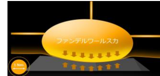
3. タイヤと路面の分子間に働くファンデルワールス力のイメージ
