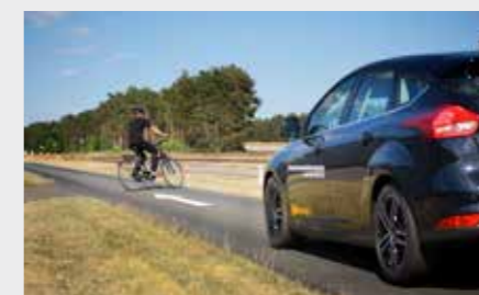
Ein Demofahrzeug mit Radarsensor und Kamera ausgestattet erfasst einen Radfahrer und warnt sobald sich dieser im Fahrschlauch des Fahrzeugs befindet.
