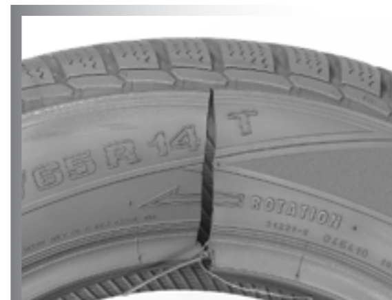
Tringle rompue par une tension de traction trop élevée lors du gonflage.
