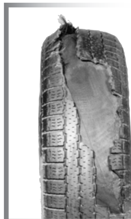
Déchirement de composants du pneu à la suite d'un manque d'entretien
