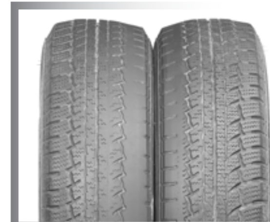
Usure unilatérale accrue due à l'inclinaison des roues. Souvent accompagnée de formation de bavures sur les arêtes du profil, voir d'arêtes usées sur les épaules.
