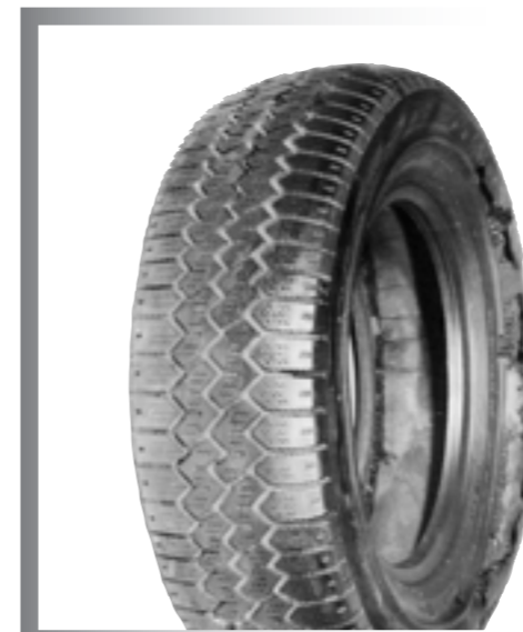
Un fort échauffement dû à un roulage en sous-gonflage très net a provoqué des séparations entre les composants et une carbonisation de la gomme.
