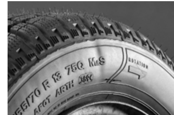
Étranglement dû au joint de chevauchement du pli de carcasse
