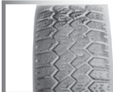
Extremer Verschleiß durch Vollbremsung (ohne ABS).
