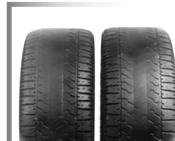
Exemple de l'aspect de l'usure de pneus montés sur l'essieu moteur d'une puissante voiture de tourisme : l'usure est nettement visible au centre de la bande de roulement.
