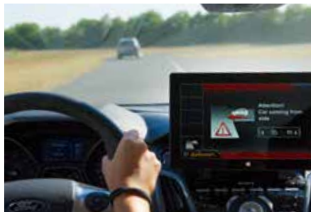
Durch die V2X-Kommunikation wird der Fahrer rechtzeitig vor Gefahrensituationen gewarnt.
